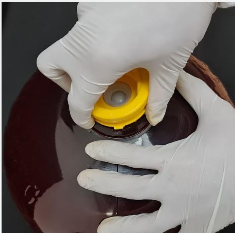
6. Sacar a Válvula com Sifão.
