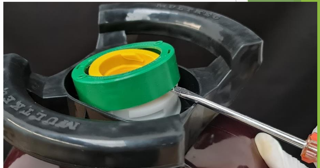
4. Fazer alavanca com uma chave de fenda média no Anel Trava de Segurança para cima, para retirada do mesmo.
