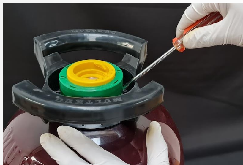
4. Fazer alavanca com uma chave de fenda média no Anel Trava de Segurança para cima, para retirada do mesmo.
