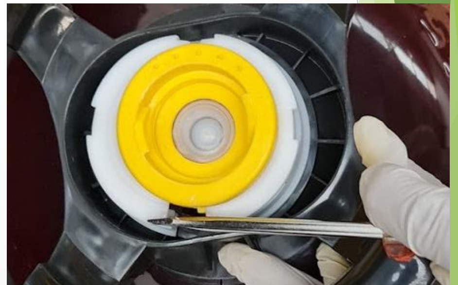
5. Abrir o Anel Bipartido usando a própria chave de fenda fazendo uma pequena pressão.
