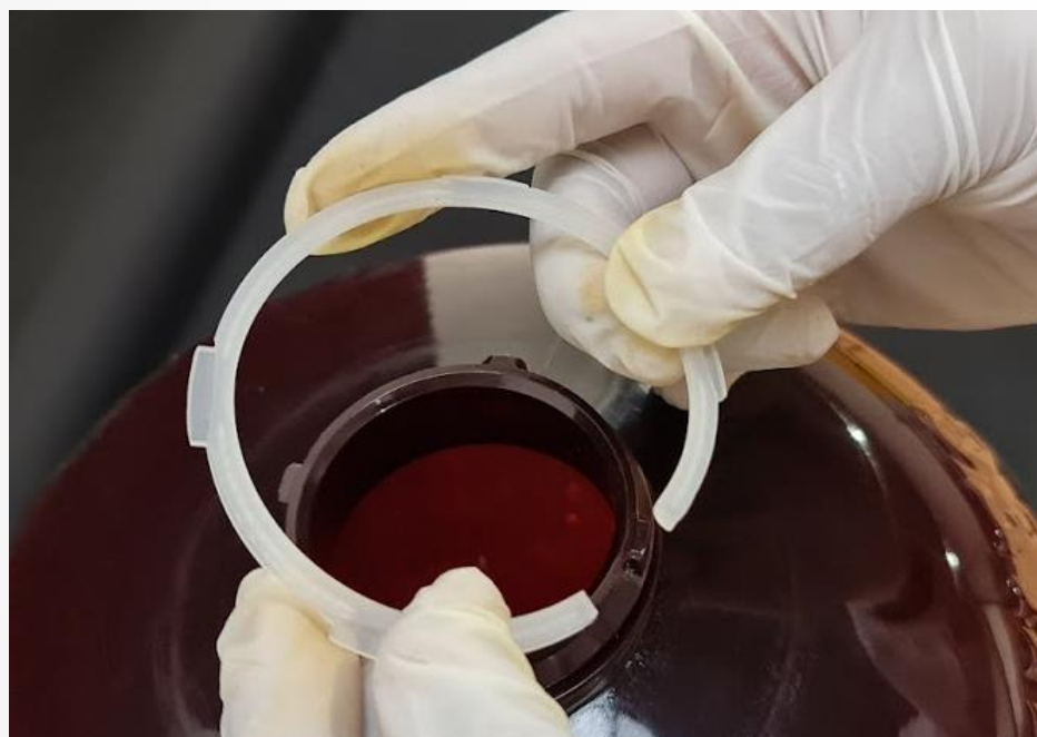
7. Abrir o Anel Centralizador e retirá-lo.
