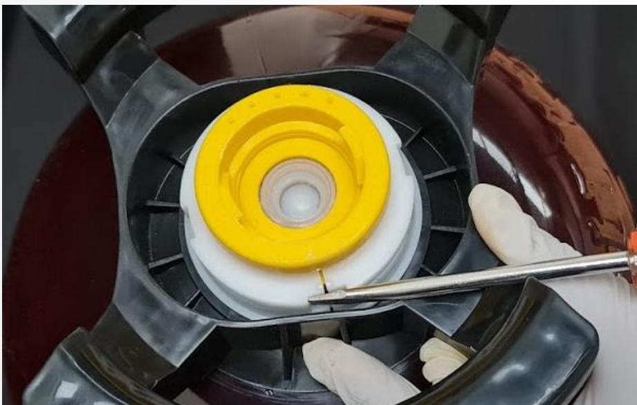
5. Abrir o Anel Bipartido usando a própria chave de fenda fazendo uma pequena pressão.
