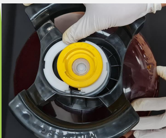
5. Abrir o Anel Bipartido usando a própria chave de fenda fazendo uma pequena pressão.
